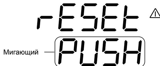
Последующее нажатие кнопки R вызывает разблокирование аппаратуры и возвращение к нормальному режиму отображения.
