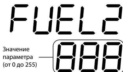
Нажатием кнопки *i* выполняется переход к режиму ИЗМЕНЕНИЕ ЗНАЧЕНИЯ ПАРАМЕТРА, при котором значение отображаемого параметра мигает.
