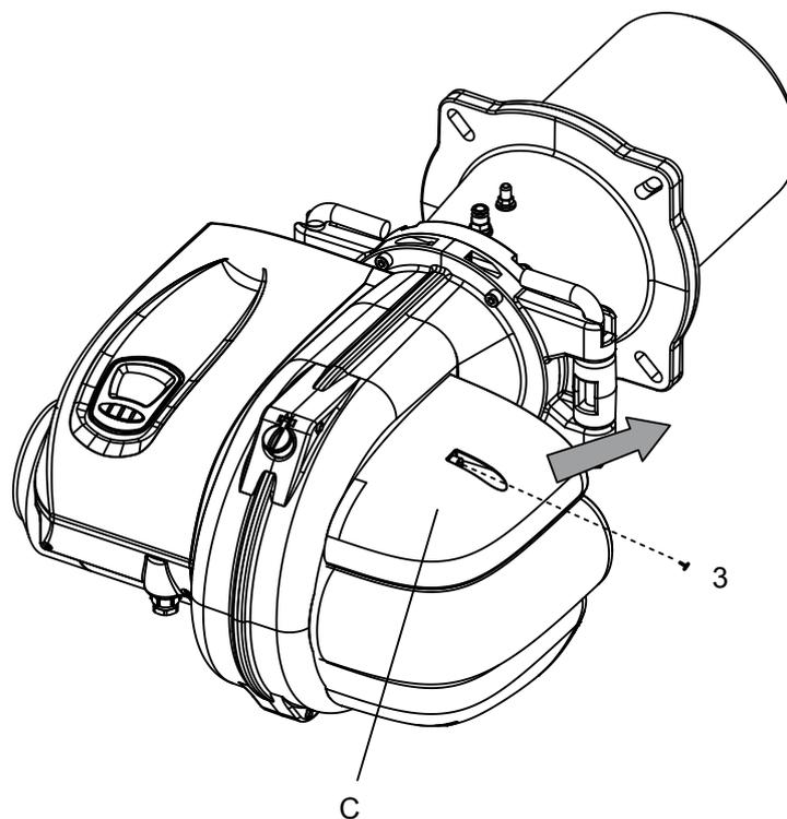
**Открытие горелки и доступ к головке горения и регулировки воздушного кольца.**
