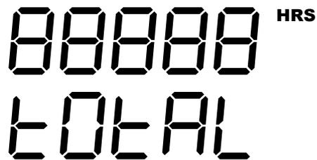
Для обнуления всех соответствующих работе горелки счетчиков, необходимо нажать кнопку **i** во время следующего отображения:
