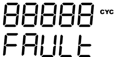
Для обнуления всех счетчиков, соответствующих циклам горелки, необходимо нажать кнопку *i* во время следующего отображения:
