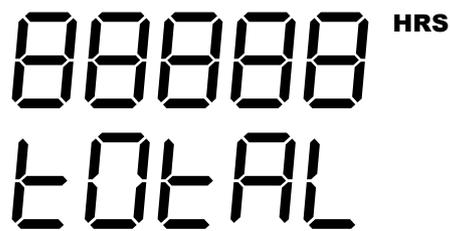
Для обнуления всех счетчиков, соответствующих расходам топлива, необходимо нажать кнопку **i** во время следующего отображения:
