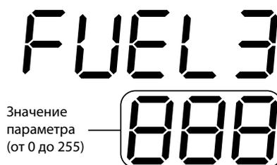
Нажатием кнопки *i* выполняется переход к режиму ИЗМЕНЕНИЕ ЗНАЧЕНИЯ ПАРАМЕТРА, при котором значение отображаемого параметра мигает.
