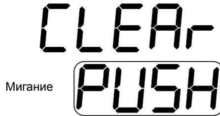
Последующее нажатие кнопки *i* в течение этого отображения определяет обнуление всех счетчиков, соответствующих часам работы, и возвращает отображение часов работы первой ступени.
