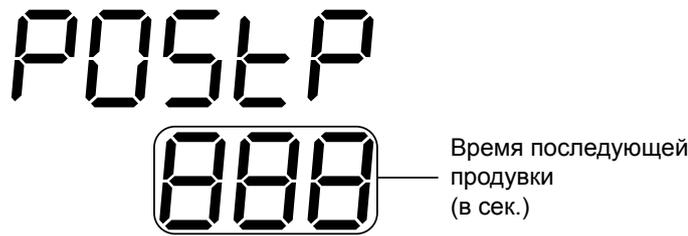
Нажатием кнопки **i** выполняется переход к режиму ИЗМЕНЕНИЕ ЗНАЧЕНИЯ ПАРАМЕТРА, при котором значение отображаемого параметра мигает.
