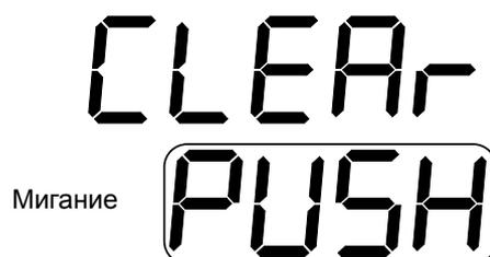
Последующее нажатие кнопки **i** во время этого отображения определяет обнуление всех счетчиков, соответствующих циклам горелки, и возвращает отображение рабочих циклов первой ступени.
