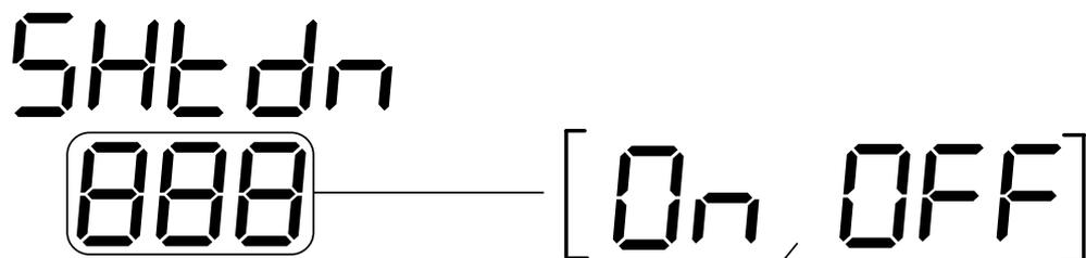
Нажатием кнопки **i** выполняется переход к режиму ИЗМЕНЕНИЕ ЗНАЧЕНИЯ ПАРАМЕТРА, при котором значение отображаемого параметра мигает.
