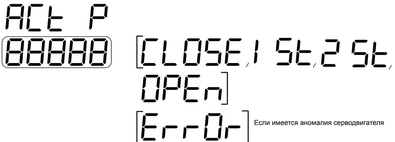
Кроме того, отображаются циклы полного открытия, выполняемого серводвигателем.
